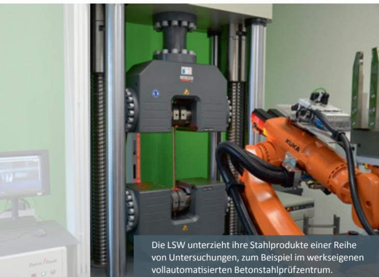
Die LSW unterzieht ihre Stahlprodukte einer Reihe von Untersuchungen, zum Beispiel im werkseigenen vollautomatisierten Betonstahlprüfzentrum.
